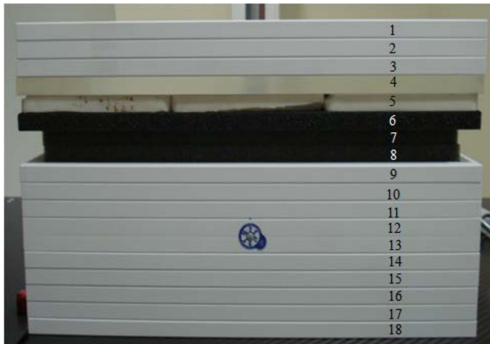
FIGURA 8: Tanto as placas de água sólida quanto as outras estruturas tiveram espessuras e áreas medidas por paquímetro da marca Mitutoyo com nônio de 0,05cm e régua comum, respectivamente.
