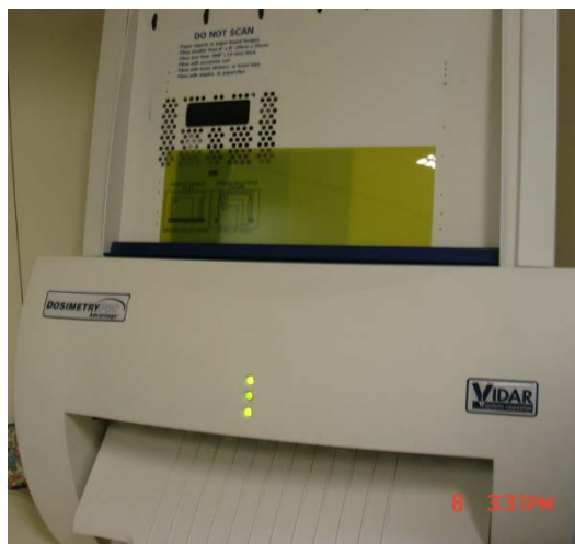
FIGURA 13: Detalhe para a orientação e alinhamento sempre constantes para todas as medidas.
