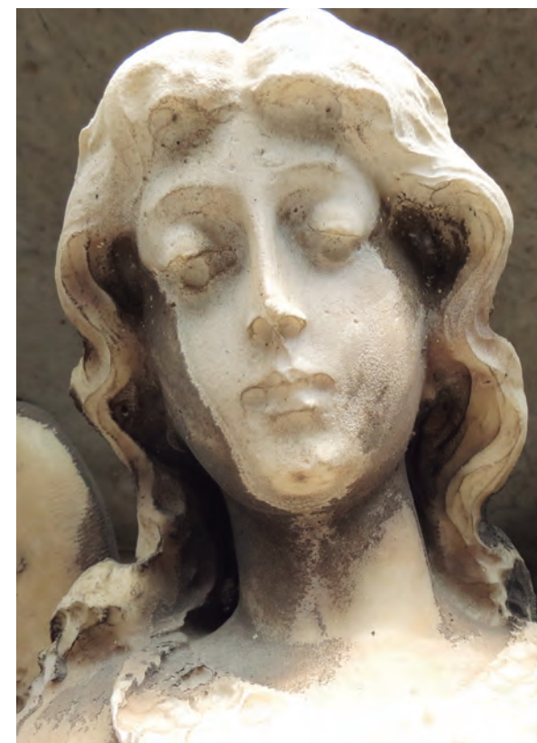
Escultura em mármore: nas áreas mais expostas à chuva ácida nota-se erosão da superfície e nas áreas mais protegidas, formação de crosta negra. Cemitério Consolação, SP, 2016. Foto: Eva K. Mori
